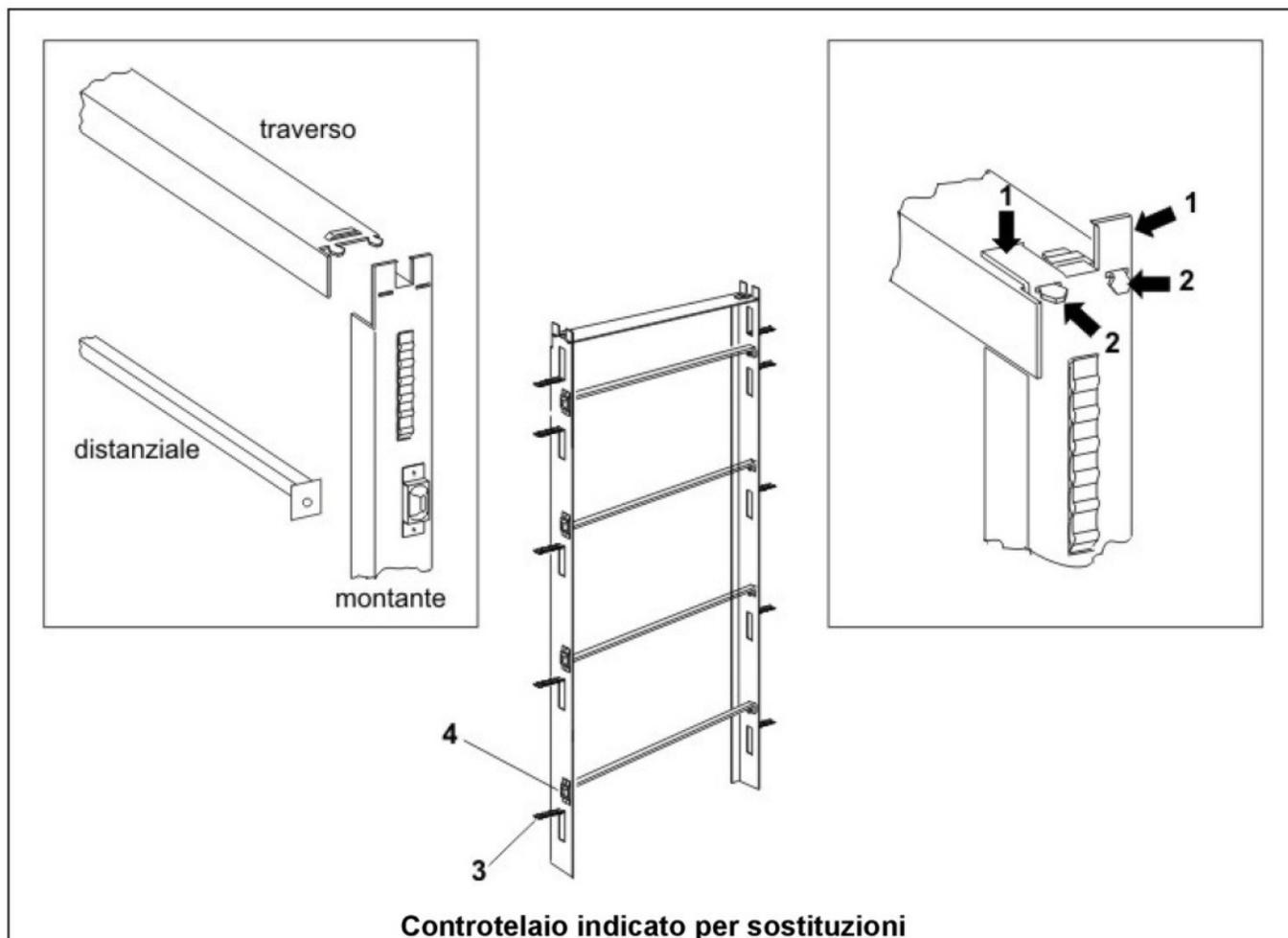
Assemblare il controtelaio a gabbiette come indicato in figura. Il traverso va manualmente unito ad incastro con i montanti e, dopo aver collegato tra loro i montanti con i distanziali in dotazione, si possono ribattere le alette di giunzione ( 1 e 2) degli angoli.
