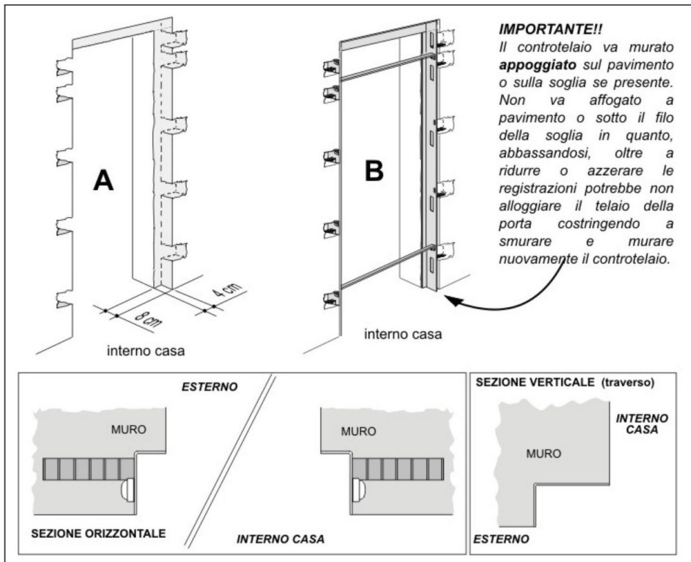
Nella figura **A** è esemplificato l'ingombro utile necessario all'installazione del controteelaio (versione con zanche a murare) lasciando una mazzetta sui tre lati di **8 x 4 cm** circa e tenendo conto delle nicchie che dovranno alloggiare le zanche (se previste) e le gabbiette.
